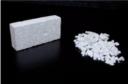
Mit Hilfe eines neu entwickelten Verfahrens, der Partikel-technologie, können wir den Verschnitt von COMPACFOAM zu 100 Prozent recyceln. **CF eco**, das Ergebnis dieses Prozesses, bietet dieselben guten Eigenschaften wie COMPACFOAM: hohe Festigkeit bei ausgezeichneter Wärmedämmung.
