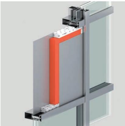
Die formstabile und druckfeste Paneelrandverstärkung von **COMPACFOAM** ist das ideale Dämmmaterial für die hohe Beanspruchung im Randbereich von Sandwichelementen.
