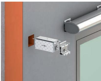
Steigende Fassadendämmstärken verlangen bei der Befestigung von Markisen nach neuen Lösungen, da bisherige Befestigungssysteme meist nur bis zu einer WDVS Stärke von 160 mm funktionieren. Die Montage soll gleichzeitig wärmebrückenfrei und einfach sein. Der innovative Montageblock **CF 200** wird diesen hohen Anforderungen gerecht.
