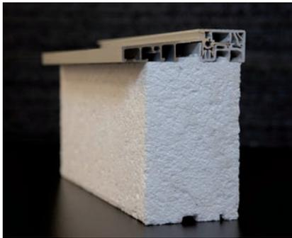
Der Trend zu immer größeren Türen und Hebeschiebeanlagen führt zu entsprechend höheren Gewichten, die auf das UDP abgetragen werden müssen. Durch die hohe Festigkeit von **CF eco** UDPs werden die Kräfte problemlos in das Mauerwerk abgeleitet. Gleichzeitig wiegen UDPs von **CF eco** etwa 1/3 weniger als herkömmliche UDPs.
